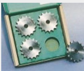
Zahnräder im VCI-beschichteten Karton. Alle grünen Flächen sind jeweils VCI-beschichtet. (D)
