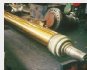
Hartgußwalze mit VCI-Konzentrat beschichtet, als grifffester Film für höchste Beanspruchung bei Freiwitterung und Salzwasseratmosphäre (E)
